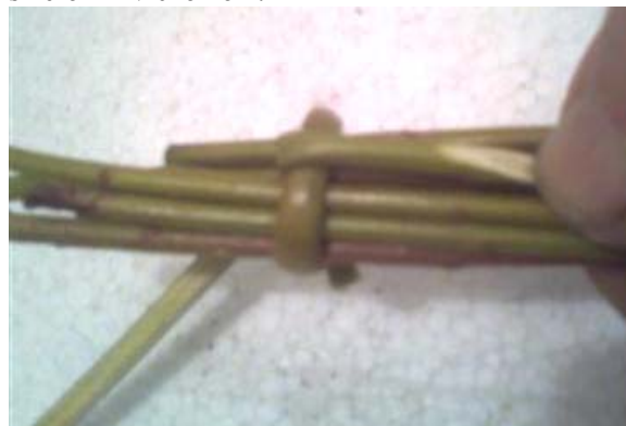
Obr. 2 Štiepka je zasunutá cez spodky tak, aby sa ďalšou otáčkou prekrížením upevnila. Cez prekríženie je zahnutý jeden prútič, ktorý ďalšia otáčka pritlačila k prútom – vytvoril sa háčik. Všimnite si prosím, že koniec zahnutého prútička je zrezaný. Omotka po ňom prechádza pozvoľne – nevytvára odskok.
