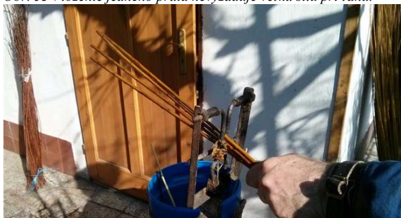
Obr. 54 Ak je niektorý prút hrubší, odtlačí ramená šúpačky a tenšie treba opakovane vložiť na šúpanie.
