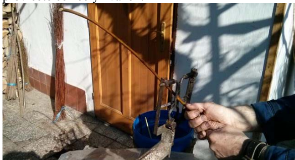
Obr. 53 Vloženie jedného prúta nevyžaduje veľkú silu pri ťahu.
