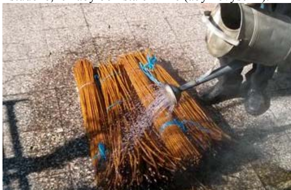
Obr. 48 Použite viac vody, resp ak máte nádrž s vodou ponorte ich tam a nechajte schladieť.
