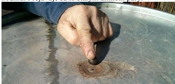
Obr. 47 Vo veku je spravená malá priehľbenina, v strede ktorej je dierka. Ložisková guľôčka zapadne do jamky na dierku. Pri zvýšení tlaku pary v nádobe sa guľôčka vychýli a umožní únik tlaku pary
