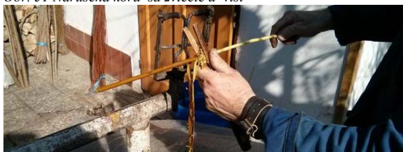
Obr. 52 Šúpačku založte pred kôru a zhrňajte. Prítlak ramien šúpačky nesmie byť veľký, inak hrozí rozvláknenie prúta (rozmliaždenie).
